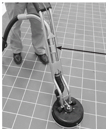
Cubierta del freno de aspiración
